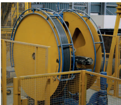
Катушки стальной проволоки устанавливаются на установку. Проволока подается со скоростью 6 метров в секунду
