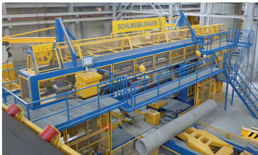
Установка для навивки арматуры компании Schlüsselbauer укладывает арматуру со скоростью до 6 метров в секунду
